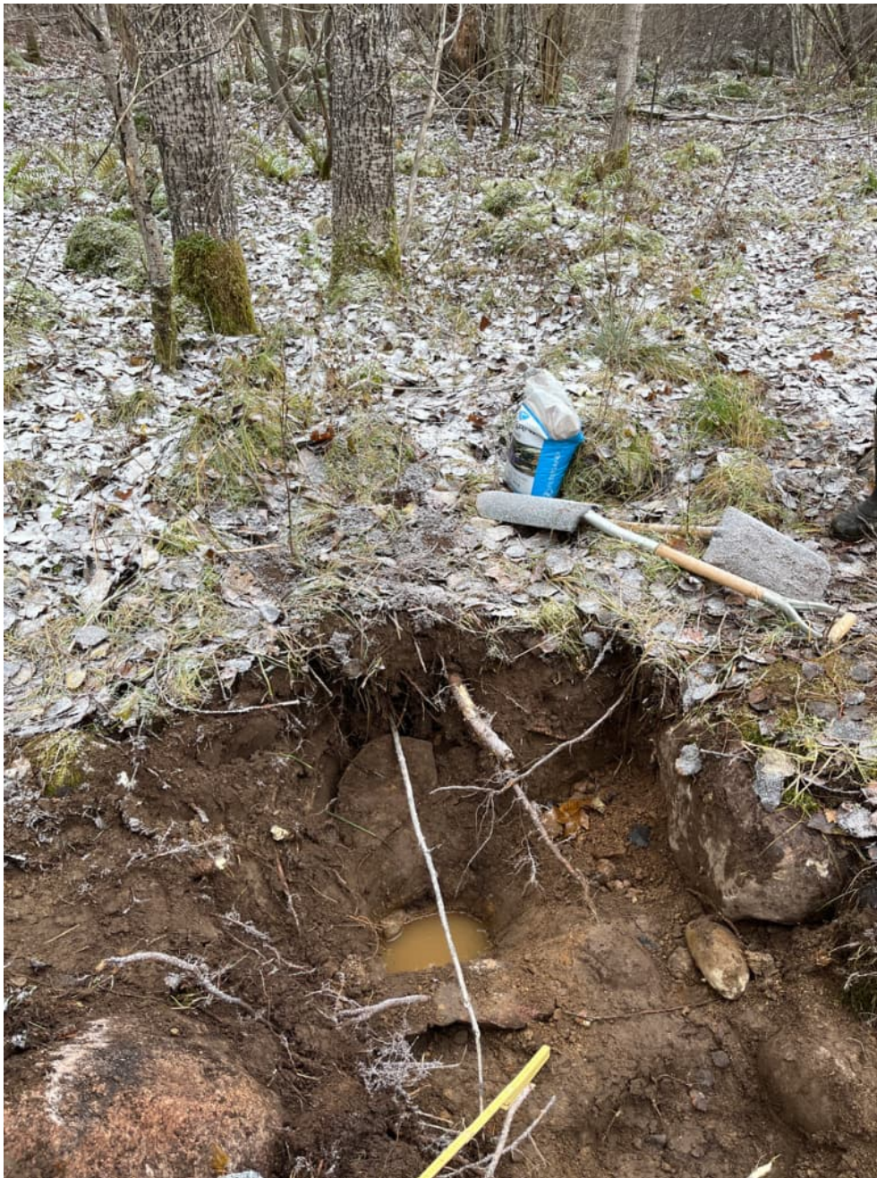
Figur 5. Bild tagen vid utfört infiltrationstest. Foto: Tyréns Sverige AB.
