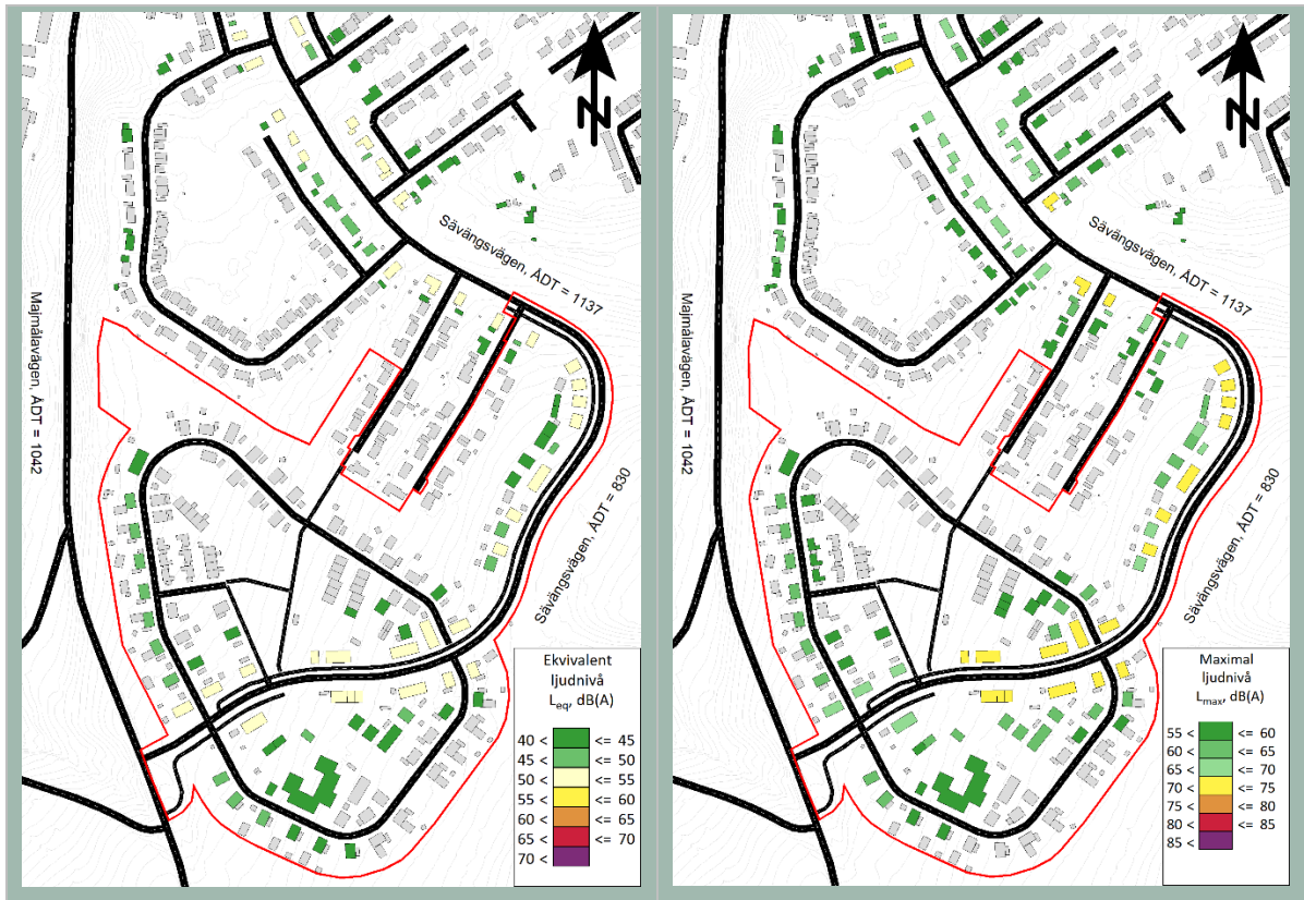
Figur 8 Utbyggnadsalternativ, närtid. Högsta ekvivalenta - och maximala ljudnivåer vid fasad. Byggnaden är färgad efter den fasadnivå vid byggnaden som är högst. Ekvivalent- vänster, maximal- höger.
